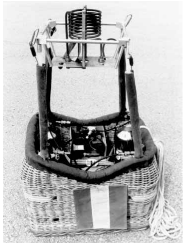
Ein „Mercedes“ unter der Modellen mit selbstgebaudem Flüssigphasenbrenner, System Wolfgang Horr, Österreich.
