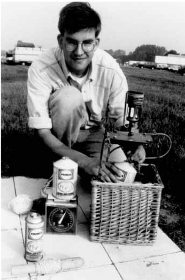
Flüssigphasenbrenner und Pilotbrenner sind eins beim klassischen Korbsystem der Gefa-Flug.
