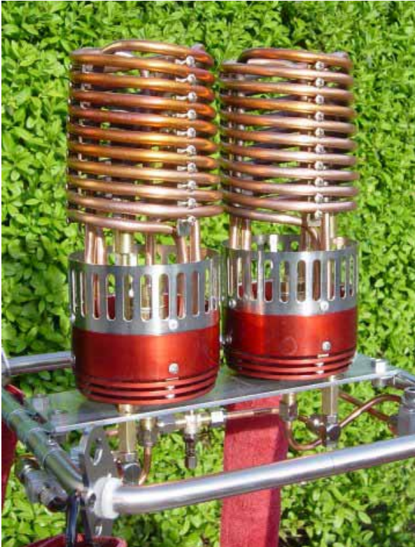
Eine Alternative zu den Brennern von BallonSport Bölling: Die Flüssigphasenbrenner der „Red Power“-Serie von Heinzballoons sind in den Durchmessern 35, 40, 50, 60 und 70 mm erhältlich. Die Abbildung zeigt den RP-70 in der Doppelbrenner-Variante.
