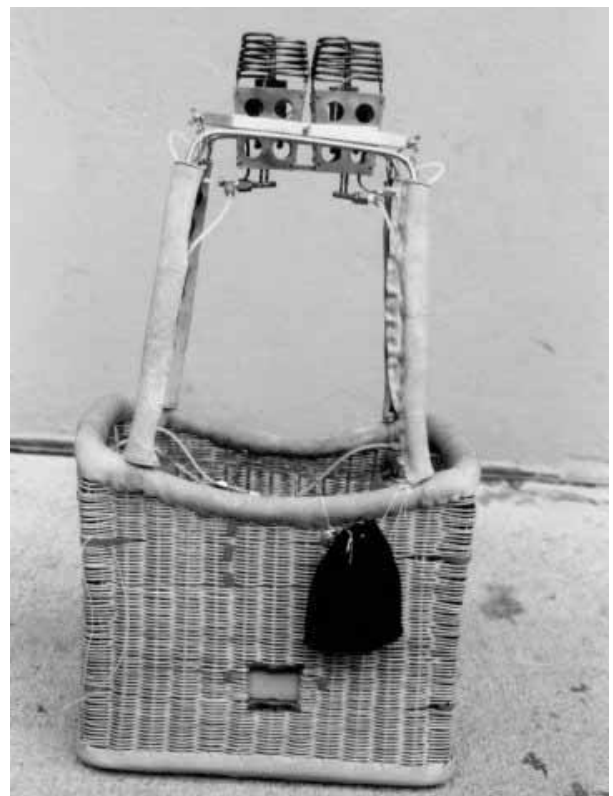
Ein bewundernswerter Semi-Scale-Nachbau eines großen Cameron Ballonkorbes mit schwenkbarem Cameron-Doppelbrenner aus Edelstahl, System Bertrand Rosat, Schweiz.
