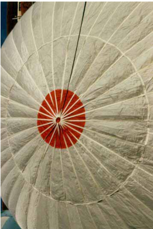
Top einer Modellballonhülle mit Lastbändern und ringförmiger Halterung für das Topseil.
