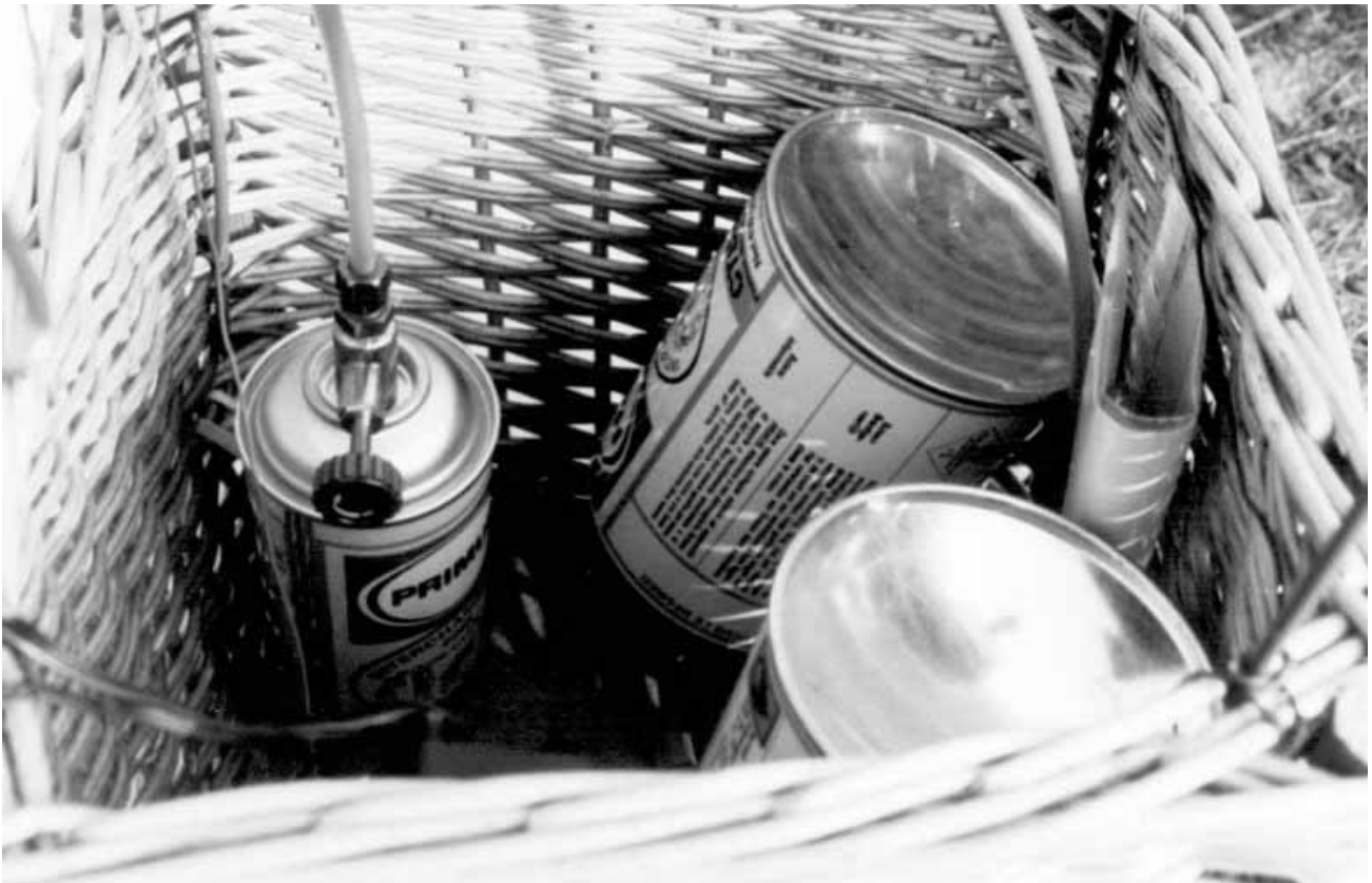
Flüssigphasenbrenner und Pilotbrenner sind eins beim klassischen Korbsystem der Gefa-Flug.
