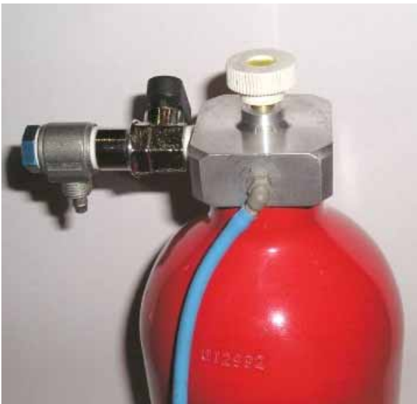
Kopf einer Leichtgasflasche von Heinzballoons. Das Entlüftungsventil ist gleichzeitig auch das Überdruckventil. (Foto: Matthias Molks, Lemgo)
