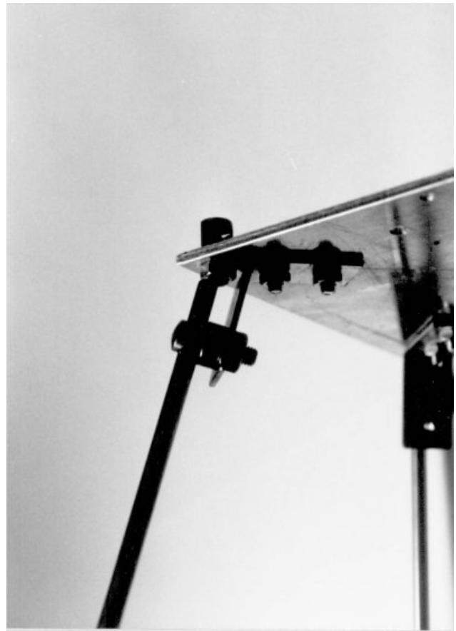
Einfaches Brennergstell bestehend aus einer Aluminiumplatte (120x120x4 mm), Stuhlwinkeln, Lochschrauben und Metallstangen.
