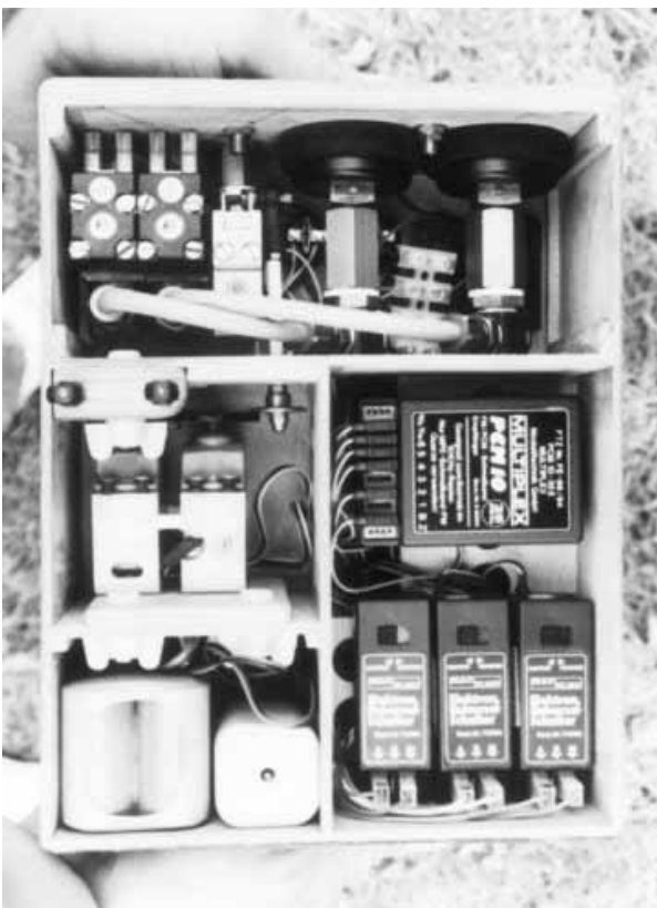
Saubere Arbeit – Ordnung und Übersichtlichkeit im Steuerkasten, System Bernhard Wedi, Emsdetten.
