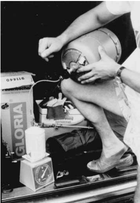
Nicht empfehlenswertes Auffüllen von Einwegkartuschen mit Butangas der Firma Camping Gaz nach Gewicht.
