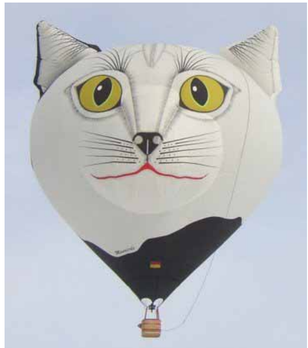
Nachbau des Katzenkopf-Ballons von Matthias & Werner Schlegel, Pforzheim. Besondere Schwierigkeit war die Form der Ohren und der Schnauze. Alle Haare wurden von Hand mit Pinsel und Lederfarbe aufgemalt.
